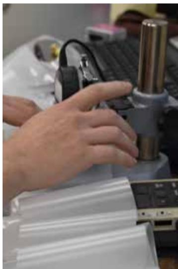
La prueba de espesor de plástico.
