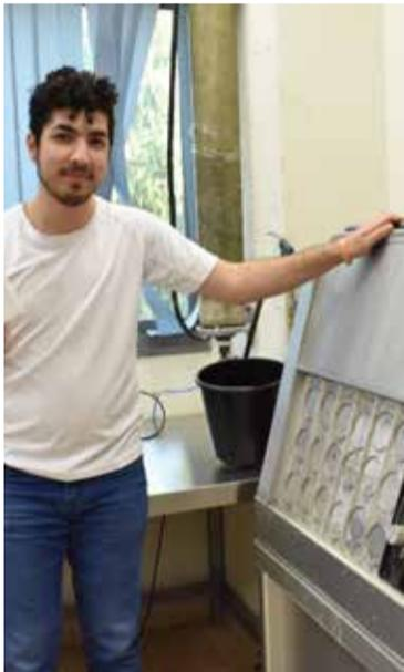
Todos los pedidos de Politiv pasan por un riguroso control de calidad. En la foto, un trabajador del departamento de calidad mostrando una máquina de radiación de rayos UV en la que realizan las pruebas de resistencia de plásticos frente a la radiación solar.
