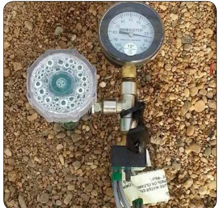
Tensiómetro electrónico utilizado en los ensayos experimentales
