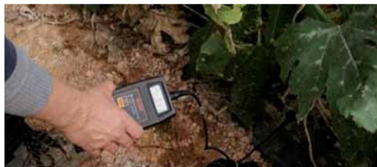
Foto 3. Medición con conductímetro de suelo en diferentes puntos.
