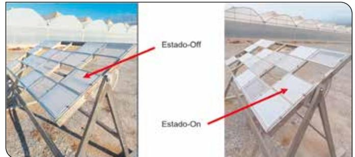
sensible para cubierta de invernaderos capaz de oscurecerse al alcanzar cierta temperatura, recuperando su transmitividad original al descender esta y desactivarse. El efecto es similar al de un sombreado móvil, pero sin la necesidad de llevar a cabo una instalación costosa, permitiendo evitar así el blanqueo de la cubierta y los inconvenientes que conlleva. Hasta ahora no existe un filme de este tipo que esté disponible comercialmente.
