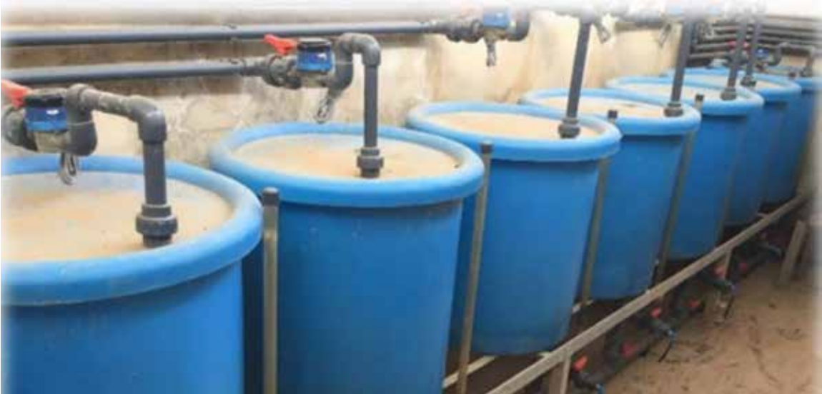
Figura 2. Cubetas de recogida de muestras de drenaje para análisis de nitratos (NO 3 -).
