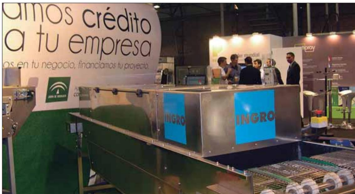
■ Máquina diseñada para la aplicación de luz ultravioleta para la desinfección del género. / FHALMERÍA
