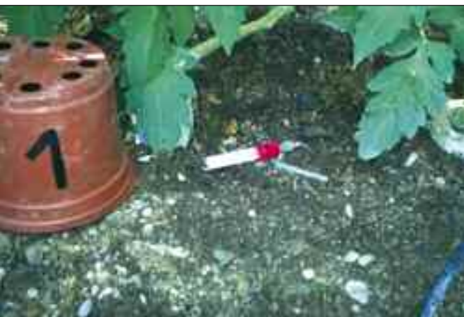
Figura 1a: Detalle de sonda instalada en cultivo de tomate.
