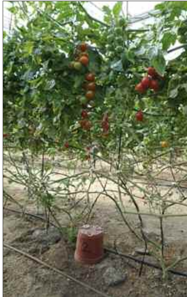
Figura 1: Una vez instalada la sonda es necesario protegerla para evitar su rotura.
