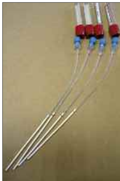
Figura 3: Sonda de extracción de la solución del suelo con tubo de vacío.
