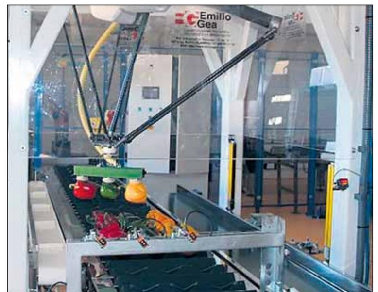
■ Sistema automático para el envasado de pimiento. /TECNOVA
