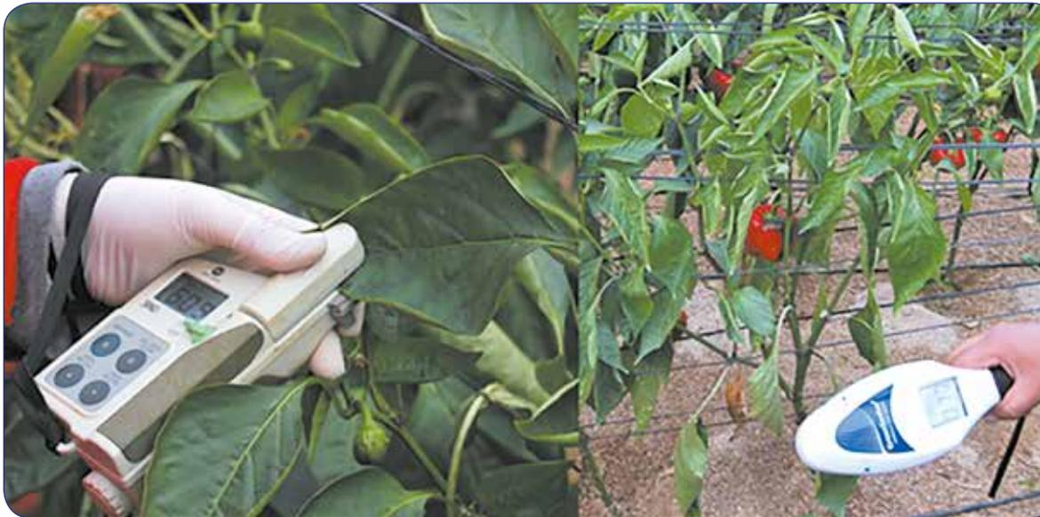
**Fotografía 1.** Medidor de clorofila SPAD-502 (izquierda) y sensor de reflectancia Greenseeker (derecha). Ambos son sensores proximales que realizan medidas puntuales en una zona de la hoja (SPAD-502) o de la cubierta vegetal del cultivo (Greenseeker).
