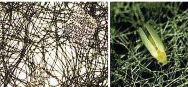
Imagen del textil no tejido tomada bajo el microscopio óptico (izqda.) e individuo de Bemisia tabaci sobre el no-tejido (drcha.).
