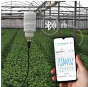
El sistema GroFit no necesita una instalación eléctrica, ya que la cápsula funciona con las pilas estándar AA y una pila de 3,6V.
